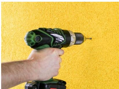
Gewinde durch die Compact- und Aluplatte schneiden.
